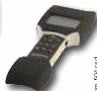
Dispositivo de localización portátil ISOM FP-60
