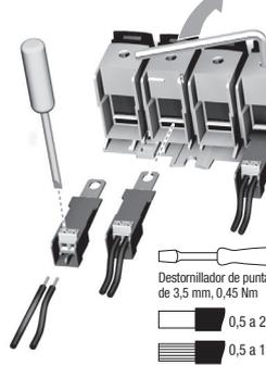
Destornillador de punta plana de 3,5 mm, 0,45 Nm
