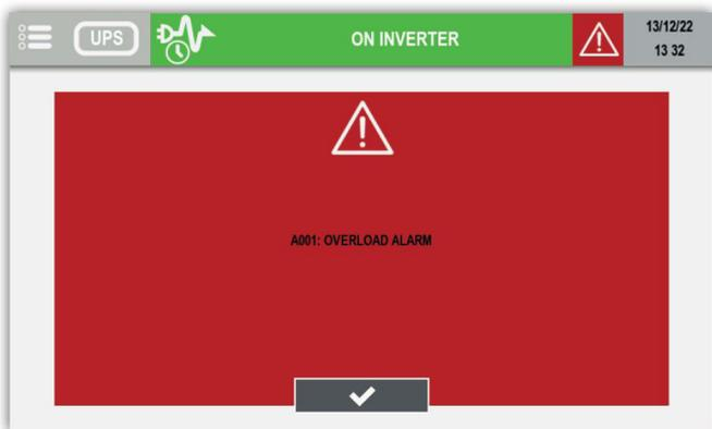
Toque un botón válido para detener el zumbador y cerrar el mensaje emergente. La página de alarma se muestra automáticamente después de esta acción.
