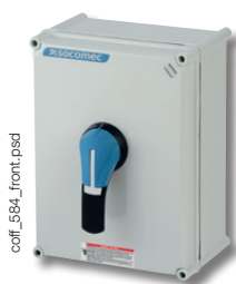
Caja SIRCO de 160 a 630 A Poliéster - IP65
